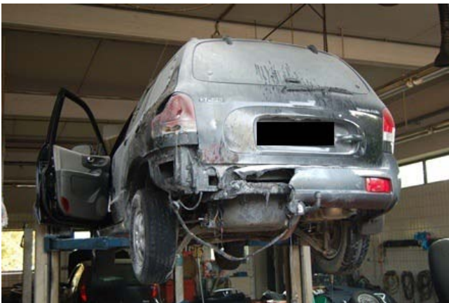
Schaden am Kraftfahrzeug und am Ventil des 80 Liter Flüssiggastanks
