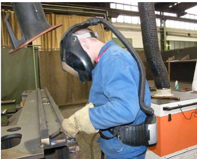
Ergonomische Schweißermaske mit gleichzeitigem, permanenten Augen-, Gesichts- und Atemschutz bei optimaler Bewegungsfreiheit und einfacher Handhabung
