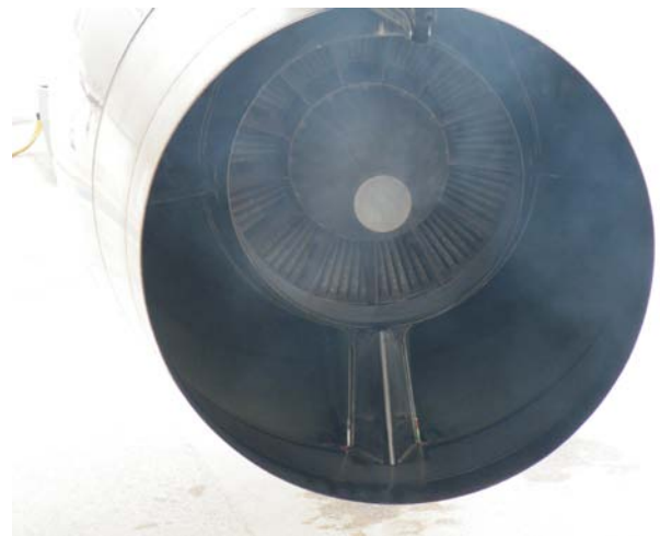
Fume-Event: austretendes Rauchgas bei Stillstand der Triebwerke
